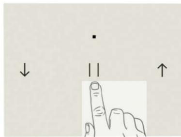
Presionado el frente del módulo durante 10 segundos en cualquiera de sus 3 botones táctiles (↓ || ↑), el módulo interruptor de cortina Wi-Fi comienza el proceso de enlace para ser dado de alta en la ampliación. El led indicador comienza a parpadear rápido y cuenta con un tiempo de 3 minutos para realizar el alta en la aplicación.
